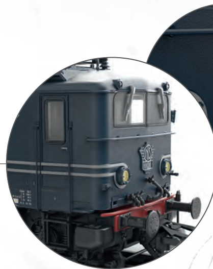
Mit ursprünglichem Lok-Aufbau aus der 1. Bauserie ohne Frontverstärkung („Botsneus“)
